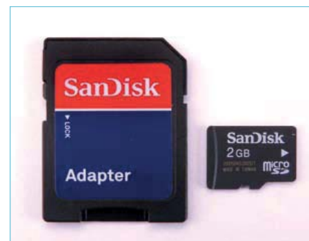
Bild 2. Eine microSD-Karte und ein SD-Karten-Adapter.
