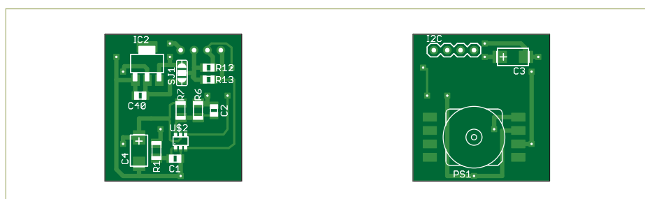
Bild 2b. Diese kleine, doppelseitige Platine ist für das Pitotrohr-Anemometer bestimmt.
