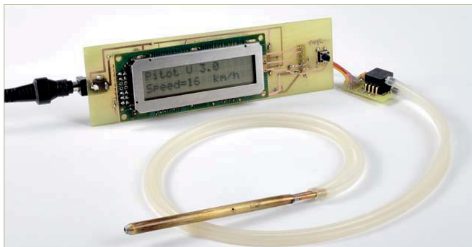
Bild 4. Zweites Labormuster des Pitotrohr-Anemometers, angefertigt vom Autor dieses Beitrags.
