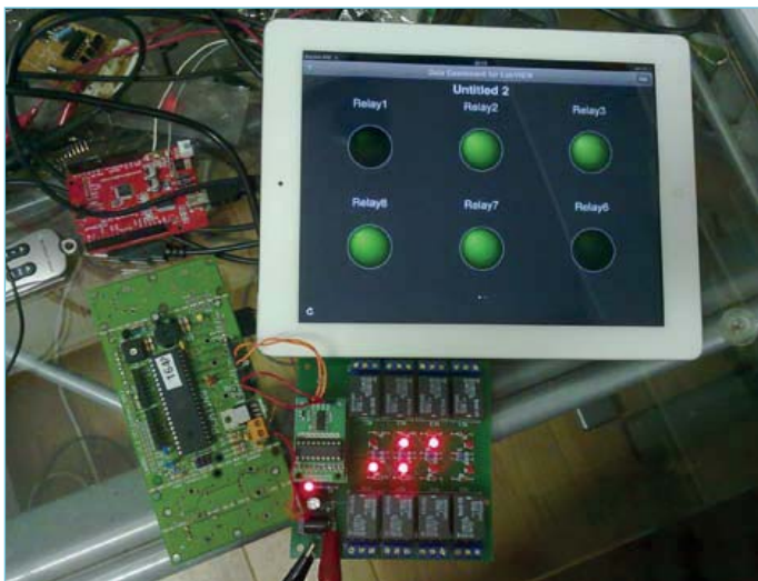
Bild 4. Das 8-Kanal-Relais-Board mit synchronem seriellen Interface, das von LabVIEW gesteuert werden soll.
